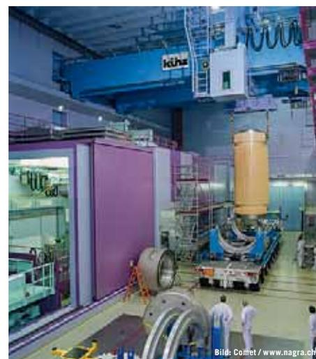
Anlieferung eines Transportbehälters für hochradioaktive Abfälle beim ZWILAG
